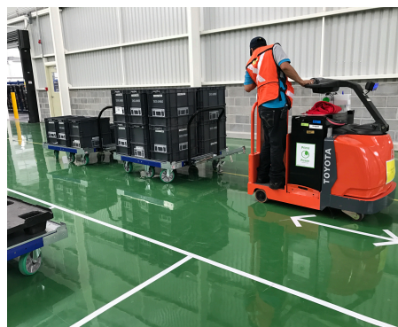
Figur 2. FlexQubevagn som dras med dragtraktor.
