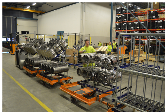
Figur 3. FlexQubevagn som dras med mor- och dotterlösning från STILL GmbH.
