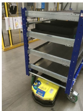
Figur 1. FlexQubevagn som transporteras med automatisk materialrobot.
